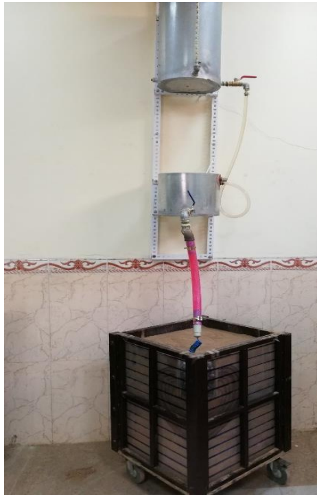
الشكل (1) حاوية التربة وحاوية الحصى ومنظومة تجهيز المياه
